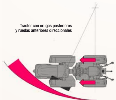
Trator com lagartas posteriores e rodas anteriores direcionais
