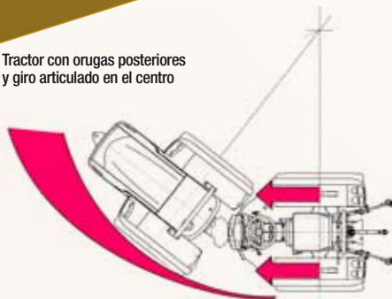
Trator com lagartas posteriores e rotação articulada no centro
